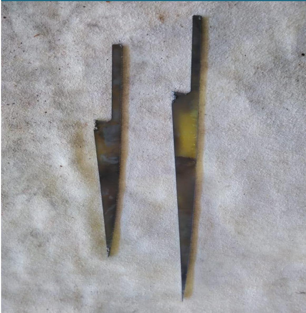
Figura 1 – Facas cortadas a plasma.
