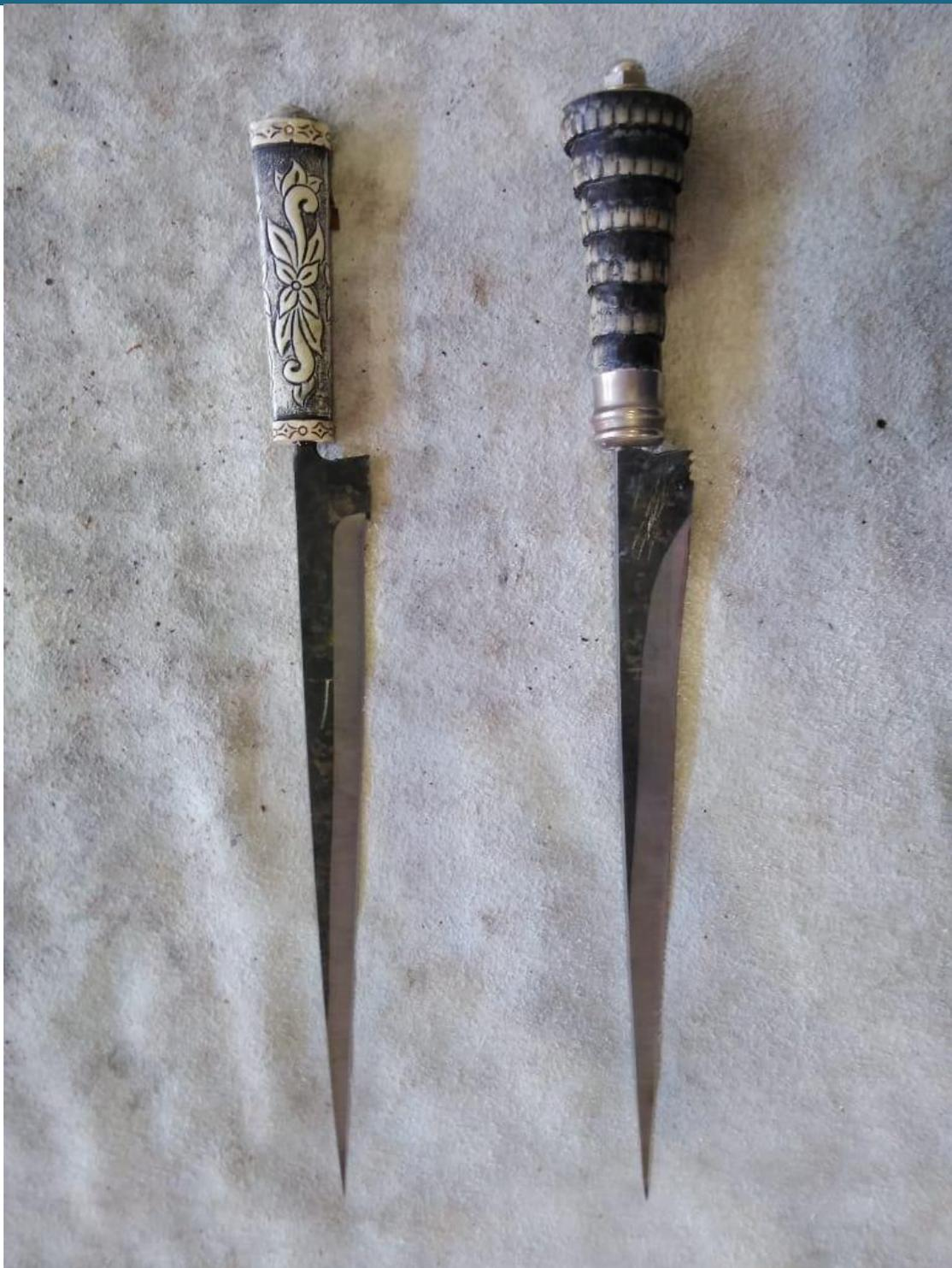
Figura 3 - Temperadas, revenidas, afiadas e com cabo.
