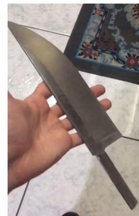
Com a faca com perfil desejado pode-se fazer os tratamentos térmicos de têmpera, utilizando uma forja de tijolos refratários com carvão e ar forçado por secador de cabelo e revenido com forno elétrico ou de fogão.
